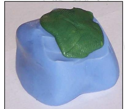
J'applique la résine dans le moule en malaxant bien pour qu'elle prenne les détails du moule.
