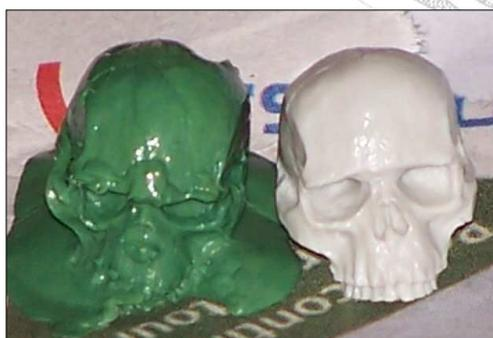
Voilà le résultat pour un crâne de 1,5 cm de taille. Bon, la qualité ne semble pas trop au rendez-vous, mais plus le volume de la pièce est important, plus il y a un risque de tassement de la résine lors d'un séchage à l'extérieur du moule et donc de perte de relief. Comparez donc avec la photo des petits crânes...
